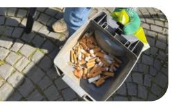
Mit nur einem Handgriff kann der geräumige Schmutz**behälter** gewechselt werden. Die Klappe kann einfach entleert und sogar ausgespült werden. Zusätzlich kommt CityBee ganz ohne Filterbeutel aus.
